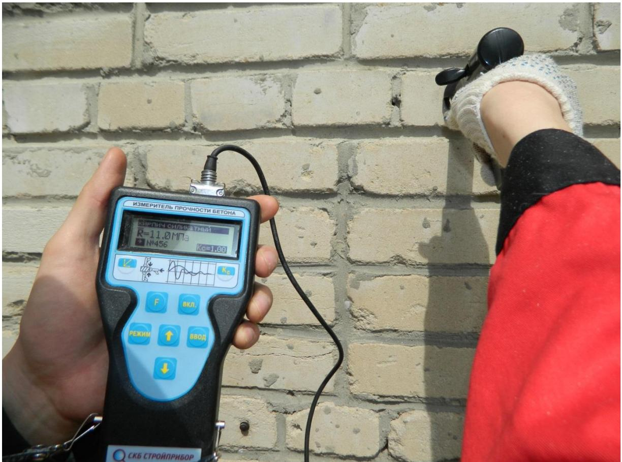
**Фотография 7.** Контроль прочности кирпичной кладки приборами неразрушающего контроля.
