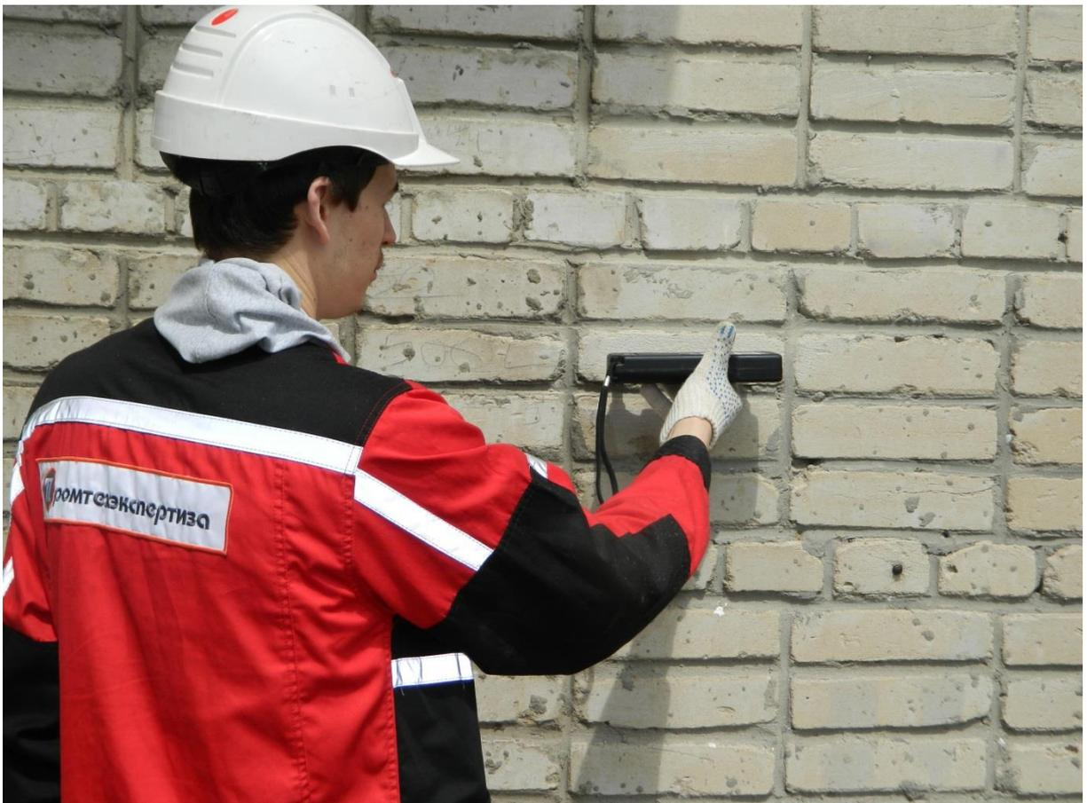
**Фотография 6.** Контроль прочности кирпичной кладки приборами неразрушающего контроля.
